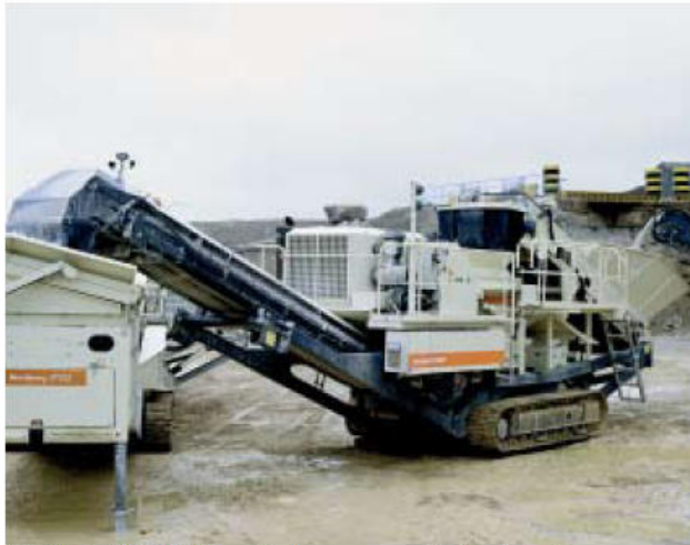
Der Lokotrack LT200HP kann einfach zusammen mit Prallbrecher- oder Backenbrecher-Vorbrechanlagen und Mobilsieben eingesetzt werden.
