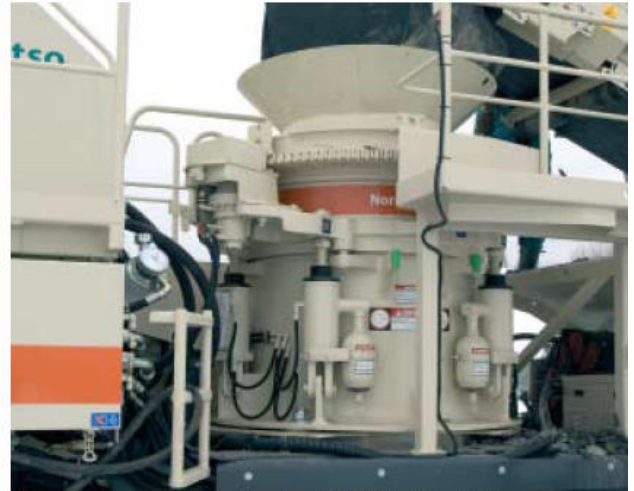
Bekannt und bewährt - der Kegelbrecher HP200 ist das Kernstück des LT200HP.
