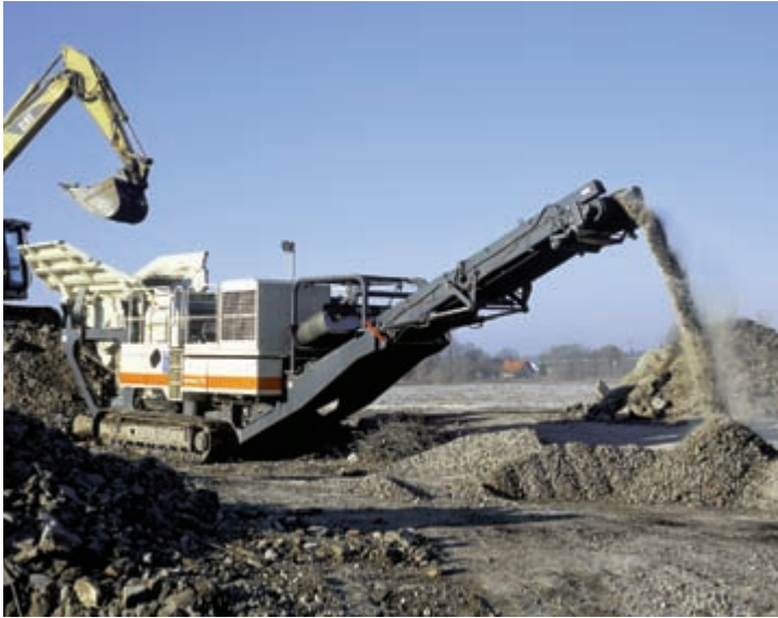
Für den Recyclingeinsatz kann der lange, robuste Austragsförderer mit einem optional lieferbaren Überband-Magnetabscheider ausgerüstet werden.
