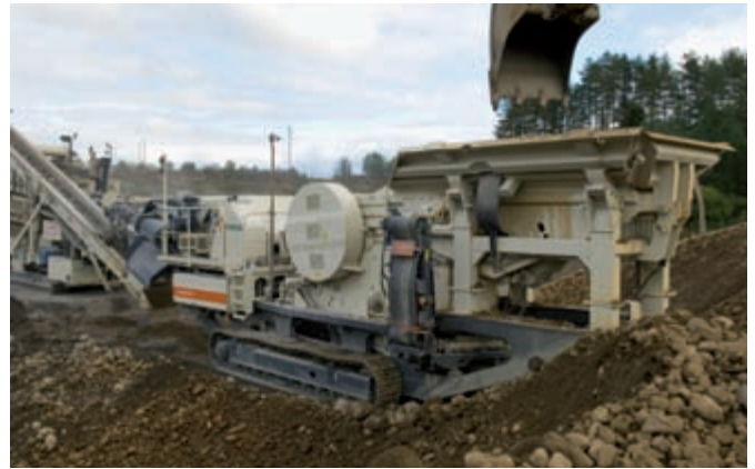
Backenbrecheranlage LT116 beschickt eine Kreiselsieb-Backenbrecheranlage LT1100.
