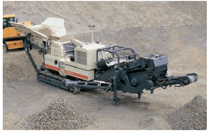
Backenbrecheranlage Lokotrack LT96S mit demontierbarer Siebeinheit.
