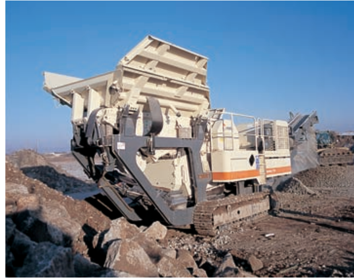
Eine weitere Besonderheit ist das automatische Verriegelungssystem für den Aufgeber, das die Zeit für die Transportvorbereitung verkürzt.
